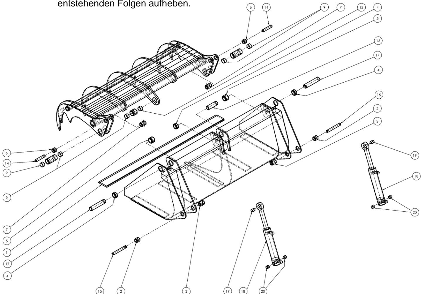
Das Bild zeigt ein Gerät mit einem mittleren Lagerpunkt. Je nach Breite sind die Werkzeuge mit keiner, einer oder zwei mittleren Lagerpunkten ausgestattet. Die Teile der Lagerpunkte sind jedoch identisch.
